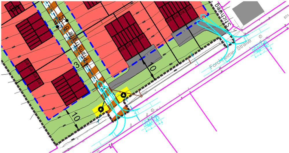
Abbildung 5: Einfahrtsituation, Schleppkurven für Müllfahrzeug 3-achsig (ohne Maßstab)
