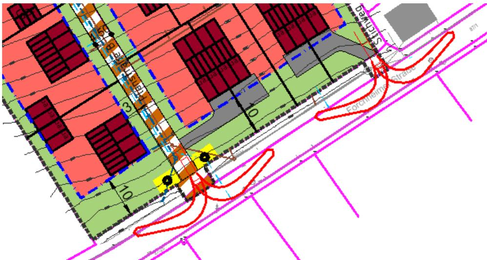
Abbildung 6: Ausfahrtsituation, Schleppkurven für Müllfahrzeug 3-achsig (ohne Maßstab)
